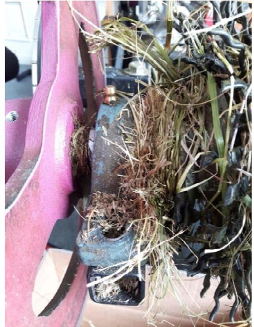
**Abb. 4: zugesetztes Lager**
